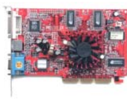
Obr. 15 Grafický adaptér (rozhranie AGP)
