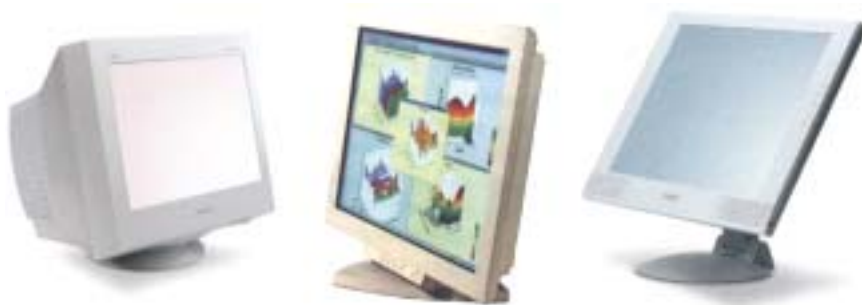
Obr. 10 Typy monitorov: (zľava) klasický CRT, plazmový a LCD
